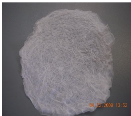
ب: نمایی از سلولز پس از تیمار و خشک شدن
