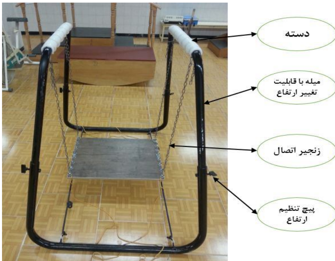
شکل ۱. تاب تعادل ساخته شده در ایران و موجود در آزمایشگاه حرکات اصلاحی دانشکده تربیت بدنی و علوم ورزشی
