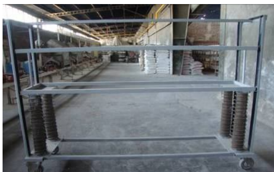
شکل 1. چرخ حمل بار طراحی شده دارای قابلیت جا به جایی عمودی در طبقات
