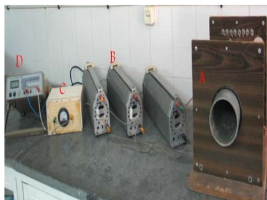
شکل ۱. سیستم مولد میدان الکترومغناطیس، A: بوبین، B: رثوستا، C: خازن، D: ولت سنج.
